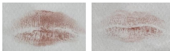
マスクに使用される不織布に口紅を塗布した唇を強く付着させたもの 左：これまでの研究品 右：フィットフィルム処方
